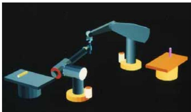
2台のマニピュレータによる手渡し作業
